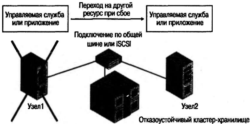
Рис. 2-19. Если в отказоустойчивом кластере выходит из строя один из серверов, его функции передаются другому серверу, при этом используется то же самое хранилище
