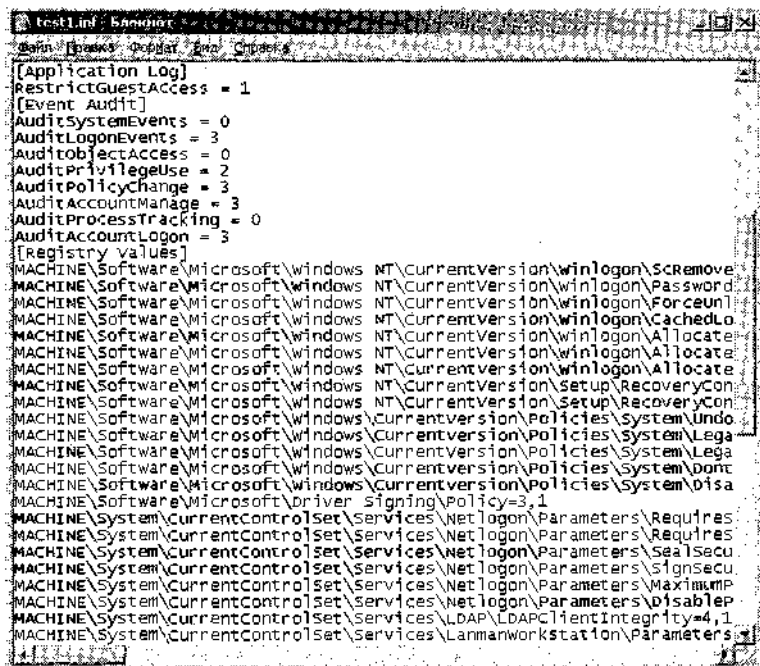
Рис. 11-6. Добавление в Inf-файл разделов реестра, которые будут затронуты при применении шаблона
