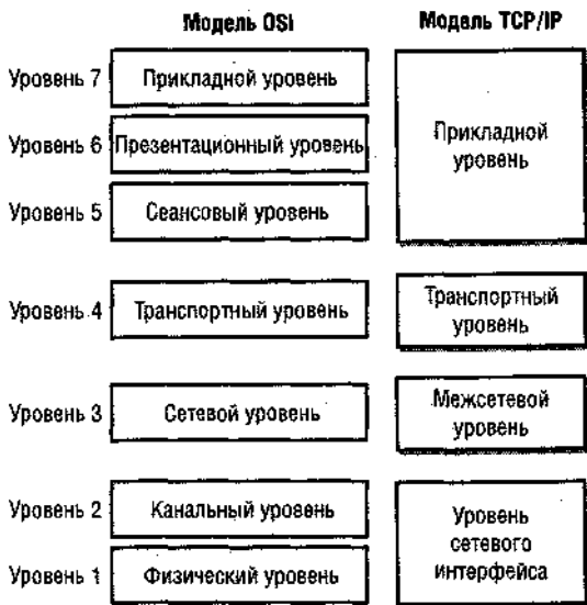
Рис. 3-6. Сетевые модели OSI и TCP/IP
